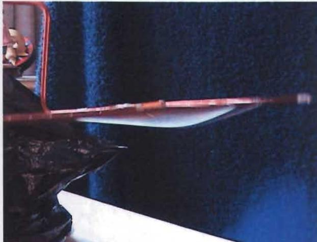
Figura 5.5: Primer estado ligado, para la geometría tipo “L.” un ángulo de doblez de  $\theta = 115^\circ$
