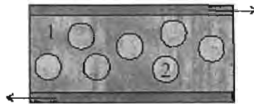
Figura 3.32: Representación esquemática del sistema considerado por el modelo de Palieme: emulsión compuesta por dos fluidos viscoelásticos incompresibles, bajo un flujo cortante simple.
