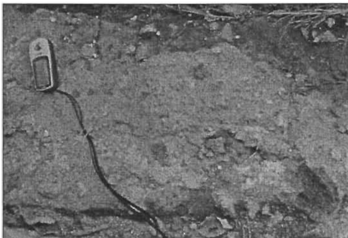
Figura 2.4. Detalle del depósito de avalancha en el poblado de Xoltepec. Fragmentos heterolíticos de formas irregulares de rocas de composición básica y riolítica inmersos en una matriz de color beige de textura areno-arcillosa.
