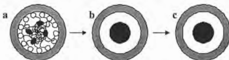
Figura 2.16. Secuencia de la incorporación de nanopartículas metálicas dentro de los canales de SBA-15. a) Precursor metálico disuelto en el núcleo hidrofóbico de la micela de tensoactivo, b) Nanopartículas de óxidos metálicos después de calcinación, c) Nanopartículas metálicas después de reducción.
