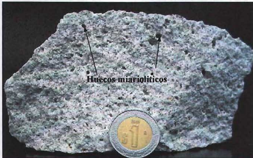
Figura 14b.- Acercamiento del granófiro, donde se puede observar la textura miarolítica, con una gran abundancia de huecos, producto de la abundancia de gases y fluidos que tenía al ser emplazado.
