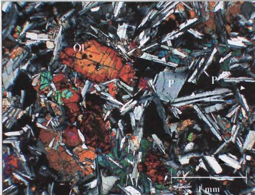
Figura 21a.- Fotomicrografía del basalto, el cual muestra su textura intergranular y su principal mineralogía consiste de olivino (Ol), plagioclasa (P) y piroxenos (Px).
