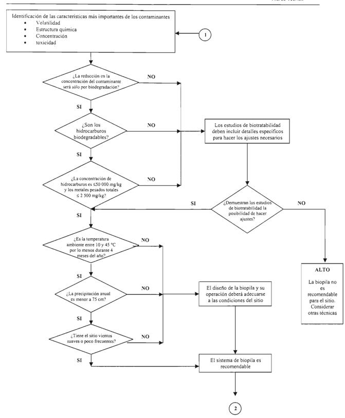
Figura 1.10. Esquema para evaluar la viabilidad de aplicar la biorremediación en biopilas (hoja 2 de 3).
