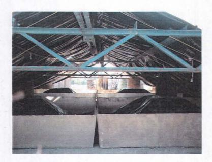
Cubierta de plástico para evitar volatilización de compuestos y agua
