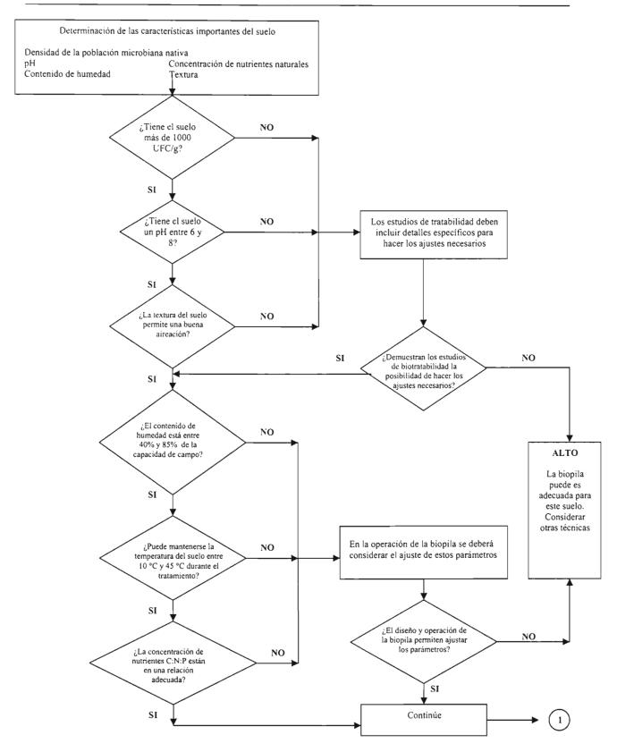
Figura 1.10. Esquema para evaluar la viabilidad de aplicar la biorremediación en biopilas (hoja 1 de 3).
