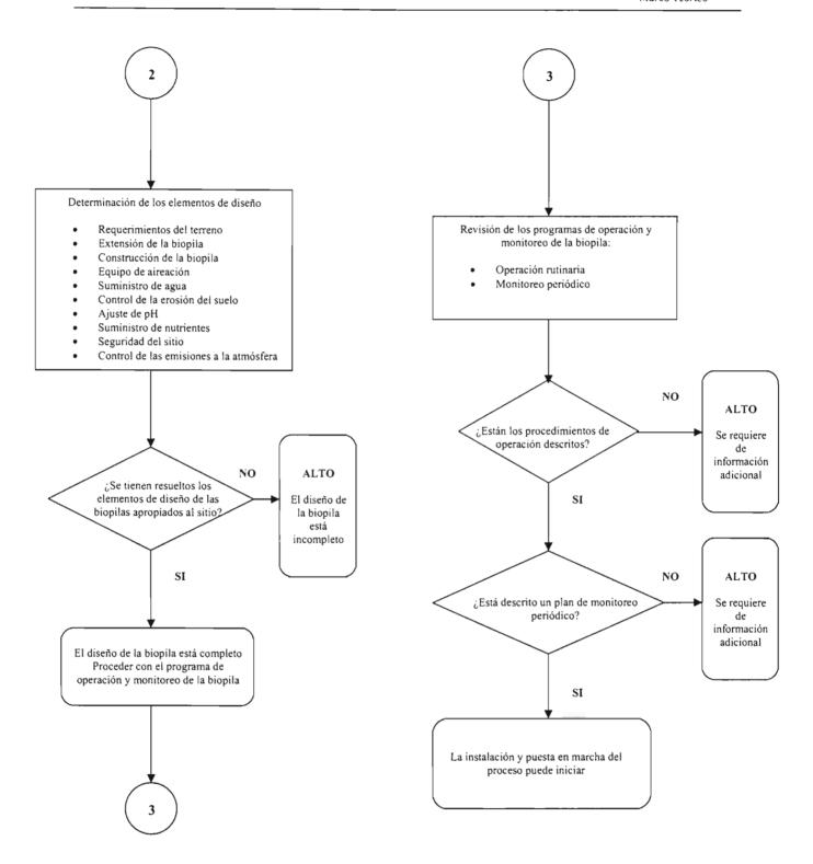
Figura 1.10. Esquema para evaluar el diseño y operación de las biopilas (hoja 3 de 3).
