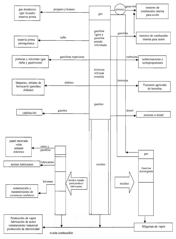
Figura 1.5. Principales fracciones del crudo y sus usos
