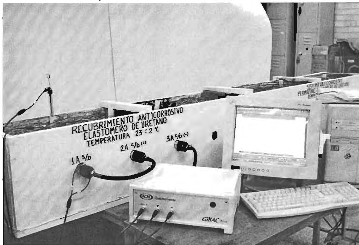
Fotografía No. 8.- Vista completa de los tubos enterrados; electrodo de referencia en el interior del tubo de PVC, extremo de los tubos recubiertos conectados al electrodo de trabajo y la malla de acero inoxidable al electrodo auxiliar. El equipo ACM Instrument GHIAC y la computadora con el Software ACM Serial # 844 versión 4.2.9, donde se realizaron las pruebas de Espectroscopia de Impedancia Electroquímica.
