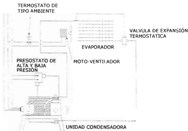
Figura 3.1 Elementos de control de una instalación frigorífica
