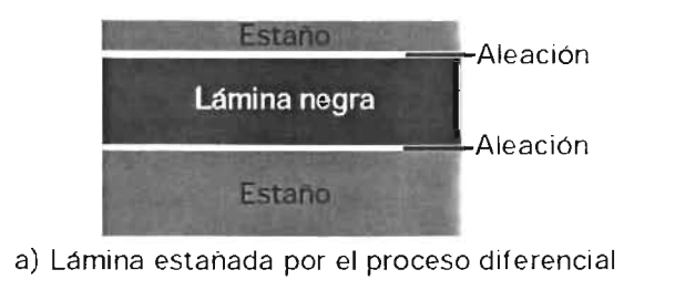
Fig. 30.- Resultado del proceso de estañado electrolítico diferencial.
