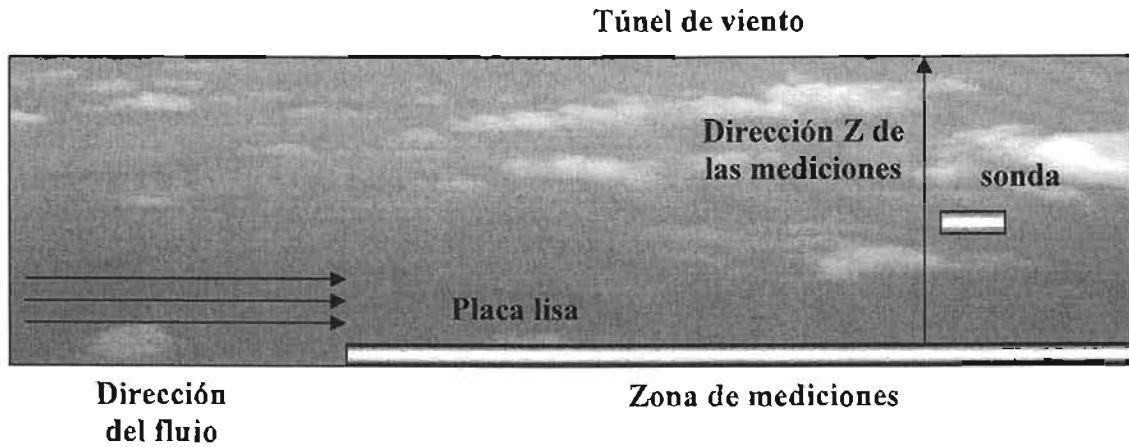
Figura 4.6. Esquema del dispositivo experimental para la capa límite turbulenta.
