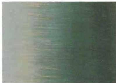
Mezclador de cerda utilizado en sentido transversal (incorrecto).
