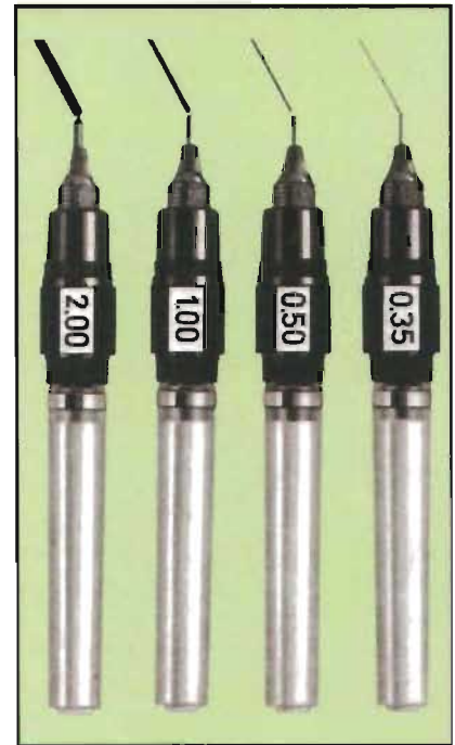
Las diferentes líneas que se pueden trazar con los diferentes puntos de la puma técnica.
