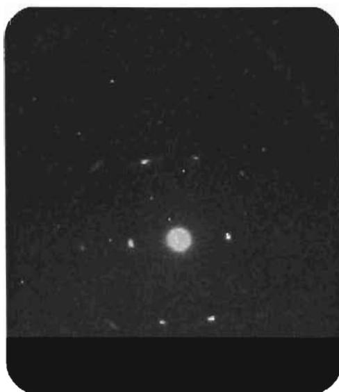
Fig. III 51. Patrón de difracción de la  $RuSr_2(Gd_{0.3}Yb_{0.7})Cu_2O_8$
