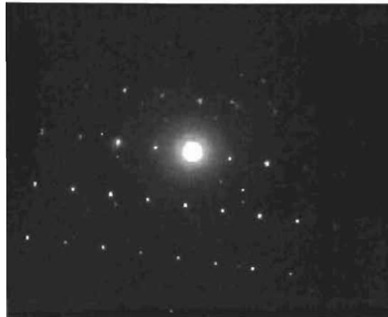
Fig. III 40. Patrón de difracción electrónica para  $RuSr_{1.9}Ca_{0.1}GdCu_2O_{8\pm z}$
