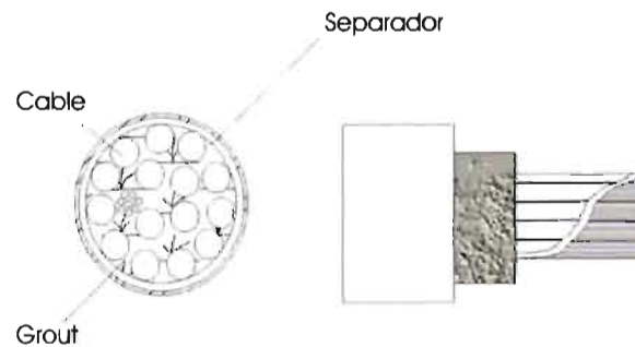
Torón de cables paralelos dentro de un ducto de poliestireno
