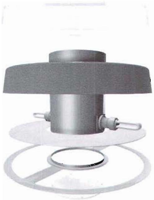
La cubierta permanece fija (remachada al tubo)
