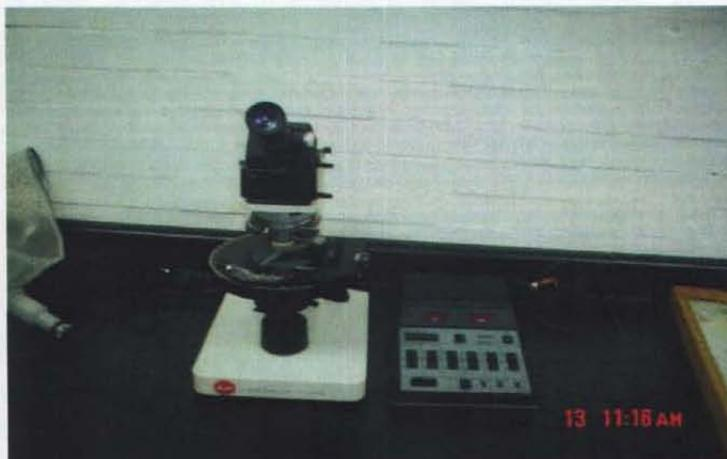
Figura 18. Contador de Puntos Con Microscopio de Luz Trasmiteda
