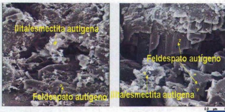
Lámina 25. El análisis del MEB de esta muestra nos combinación de arcillas illita/esmectita sobre los granos, feldespato autígeno, la illita/esmectita actua como reductora de porosidad.
