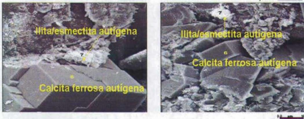
Lámina-28. El análisis de (MEB) del Núcleo-1 de la arenisca "M", muestra claramente como el cemento de la calcita ferrosa autógena y la illita/esmectita obturan los poros intergranulares ambos disminuyendo parcialmente la porosidad y la permeabilidad, aquí se observó dos tipos de cementación la primera fue la calcita ferrosa y la segunda la illita/esmectita autógena.
