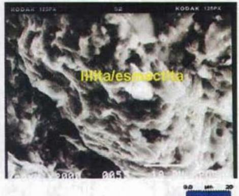
Lámina 20. Parte media del Núcleo-2 el análisis del MEB de la arenisca "M" muestra cuarzo clástico, combinación de illita/esmectita, porosidad intergranular, illita fibrosa así como siderita. La combinación de las arcillas, la siderita actúan como reductores de la garganta de poro.
