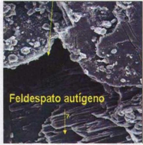
La lámina-23. Parte Media del Núcleo-1 mediante el análisis del MEB a la arenisca M<sup>1</sup> se determinó, siderita, illita/esmectita, cemento de calcita ferrosa, Feldespato autigeno, porosidad intergranular.
