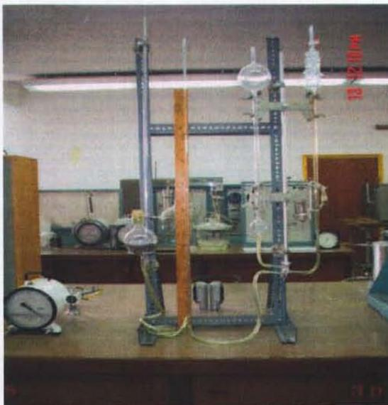
Figura 19. Porosímetro de Gases
