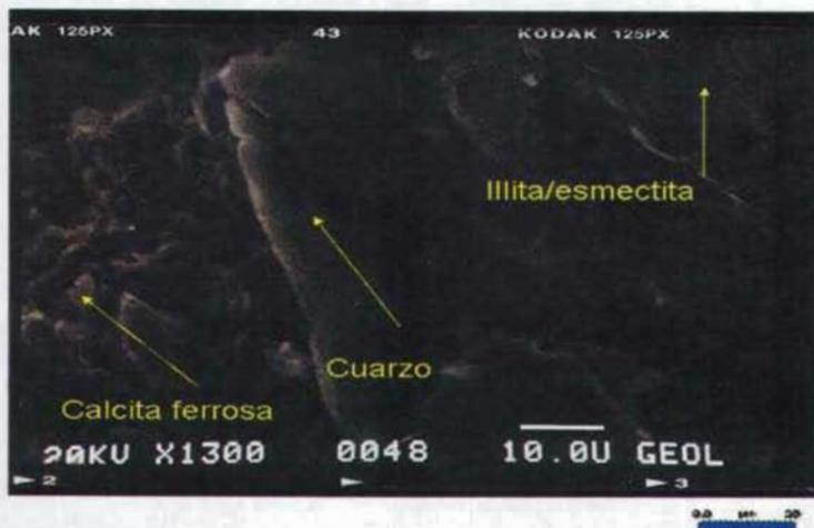
Lámina 21. Parte Inferior Núcleo 2 mediante el MEB se determino en la arenisca "M" cuarzo autógeno, calcita ferrosa como cemento, combinación de arcillas illita/esmectita.
