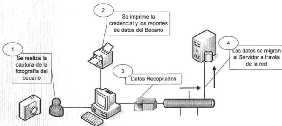
Figura 4.8 Diagrama del Proceso Automatizado
