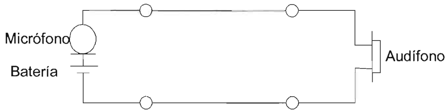
Figura 1.2. Circuito telefónico simple.
