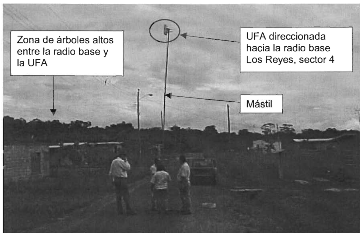
Figura 4.34. Pruebas de radiación de RSS en Monte Cristal.
