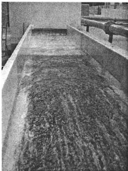
Fotografía B.15. Transporte de sedimentos en el canal (vista hacia aguas abajo)
