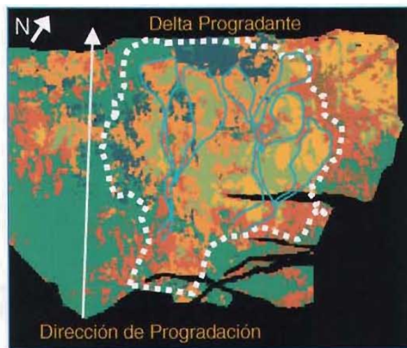
Fig. V.7 Mapa, Clasificación de facies sísmica, muestra la distribución del delta.
