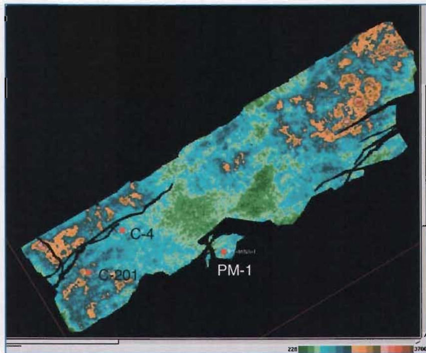
Fig.- IV.21 Mapa de amplitud RMS, colores verde obscuro-claro amplitudes bajas, azul claro-oscuro amplitudes moderadas y de café claro – rojo amplitudes altas .
