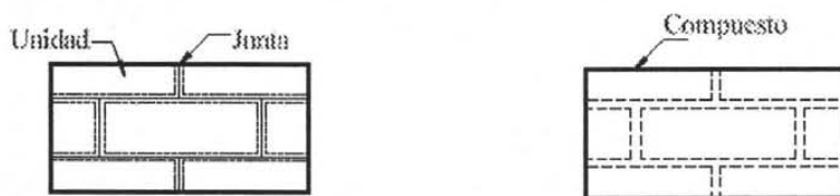
Fig 24 Formas de modelar estructuras de mampostería (Mendoza, 2005)
