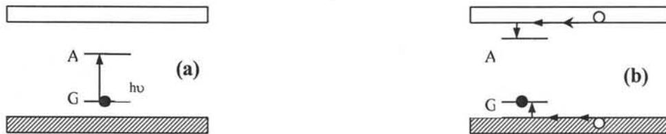
**Figura 3.** El estado base G y el estado excitado A de un centro luminiscente. (a) La excitación es debida a la absorción directa de un fotón. Otra forma de excitación, (b), por la captura de un hueco en G y un electrón en el estado excitado A.
