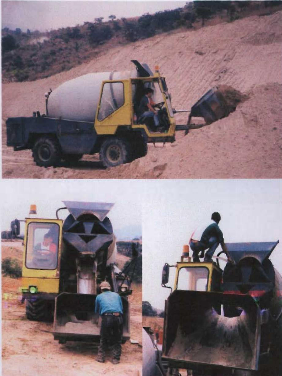
Figura 2.1 Elaboración de suelo cemento fluido en obra, con olla revolvedora autocargable.
