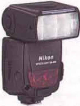
Tienen un sensor en la parte frontal que al captar la luz rebotada en el sujeto, determina cuando se ha conseguido la cantidad correcta de luz y detiene el destello. Con un flash de este tipo, basta con utilizar un diafragma medio y no preocuparse de la distancia, dentro de ciertos límites.
