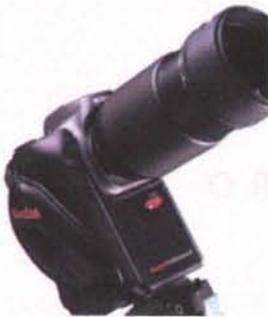
En la mayoría de los nuevos modelos puede sustituirse el panel trasero o acoplarse al mismo un respaldo digital, de forma que es posible obtener imágenes de altísima resolución y cuyo tamaño alcanza varios gigabytes. El alto grado de control de la imagen, así como la utilización de grandes formatos (algunas hasta 24x30 y más), hacen que sea la cámara ideal para publicidad y temas que vayan a sufrir enormes ampliaciones.
