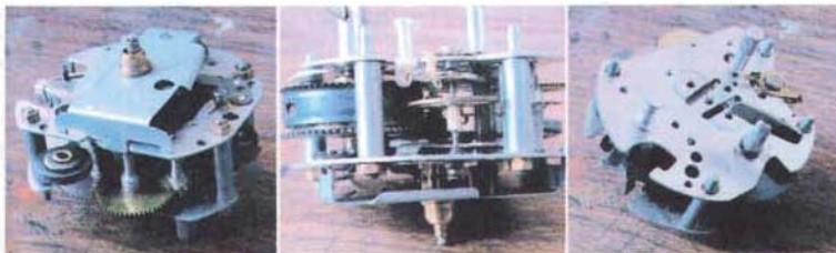
Estructura mecánica del despertador de cuerda.
