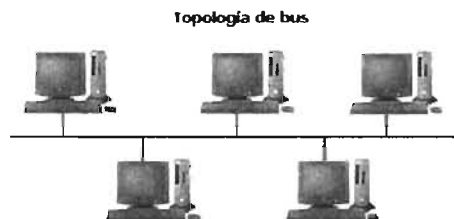
FIGURA 2.5.1. TOPOLOGÍA DE REDES TIPO BUS
