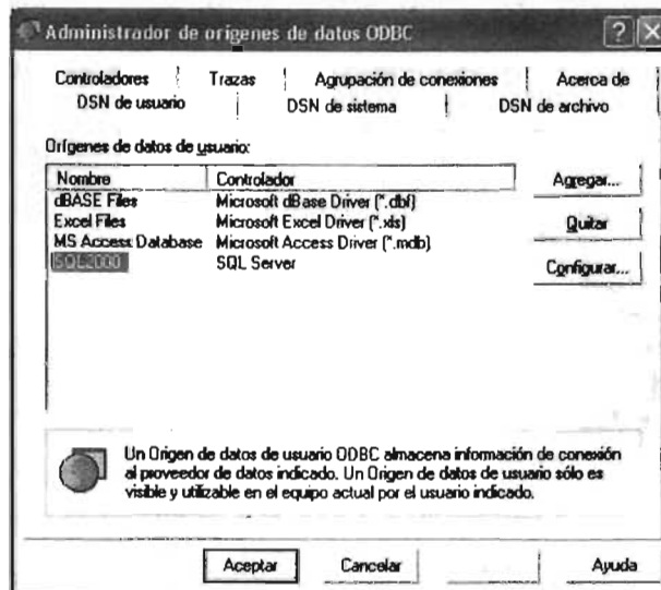
FIGURA 13. AGREGANDO ORIGEN DE DATOS PARA LA CONEXIÓN ENTRE EL SERVIDOR SQL2000 Y NUESTRA APLICACIÓN SICOES
