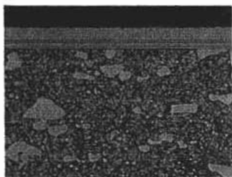
Figura 4.28.- Recubrimiento tipo sándwich compuesto de TiC-TiN-TiCN mediante CVD.
