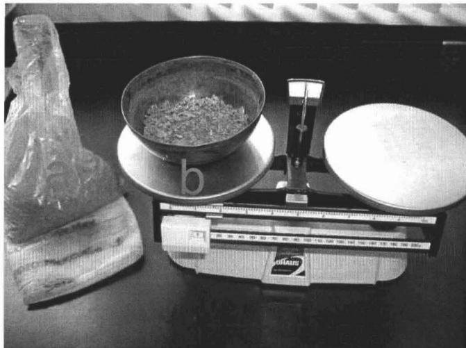
Fig.IV.1 Técnica de lavado, muestra de mano (a); de la cual se pesan 200 g (b) y el resto se deja como testigo.
