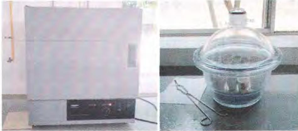
**Figura 3.15** Determinación de los SST
