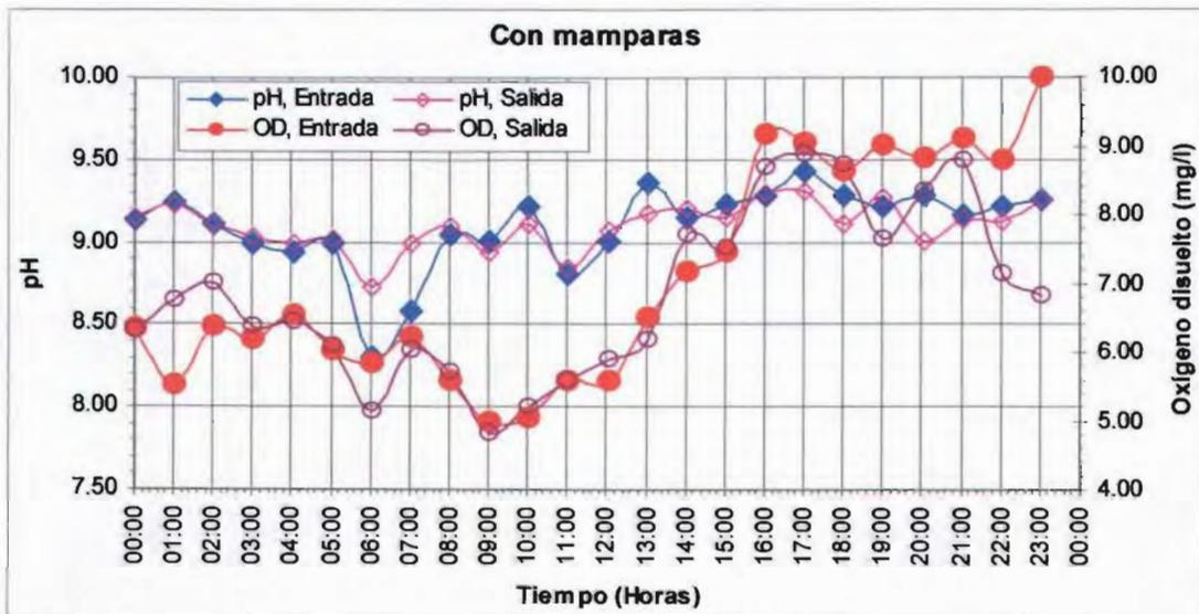
**Figura 5.27** Comparación entre el pH y el oxígeno disuelto en la laguna con mamparas
