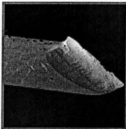
**Fig. 11.** Imagen de una punta de platino-iridio fabricada mediante corte en ángulo con pinzas de corte.
