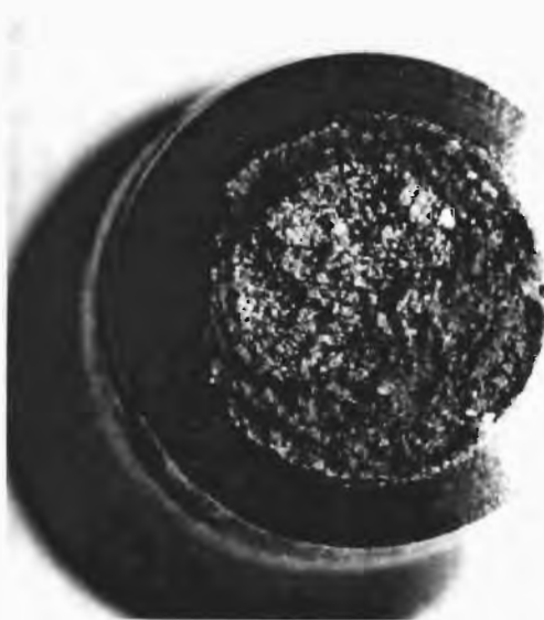
Figura 2.31 Superficie de una muestra con entalla de un acero 1025 en el que parte de la fractura es frágil y parte dúctil, mostrando zonas de microcavidades y de clivaje, en la imagen de microscopía electrónica se observa la zona de transición. (Stahleisen, 1997).
