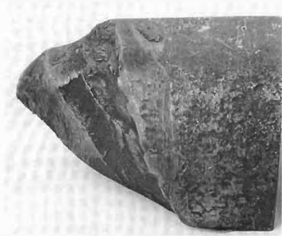
Figura 2.29 Sección del eje de la figura 2.28. El ángulo y características de la superficie de fractura corresponden a una falla frágil producto de la presencia de cortante puro (torsión) (UDIATEM, 2004b).
