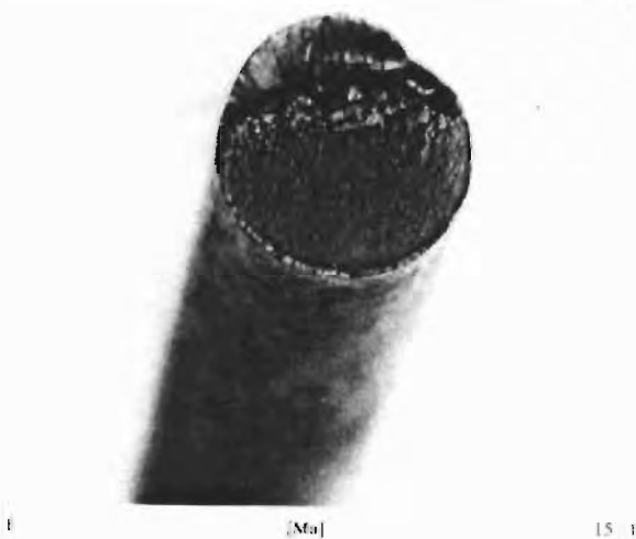
Figura 2.6 Muestra de un alambre de acero galvanizado y recocido el cual se sometió a flexión rotativa. La fractura se inicia en la superficie del defecto y se propaga perpendicular al eje del alambre. (De Ferri, 1979).
