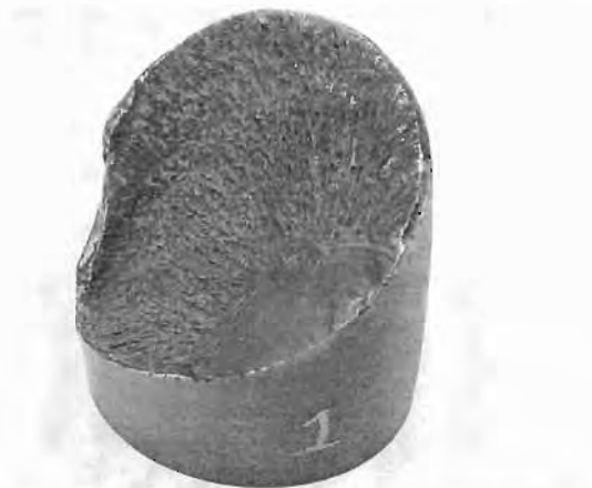
Figura 2.11 Imagen de la superficie de fractura de una barra de torsión de autobús (UDIATEM, 2004a). Se distinguen claramente las dos regiones (pulida y granular).
