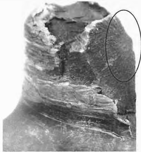
Figura 2.30 Detalle de la zona de fractura. Por la dirección de las marcas de Chevron la grieta corre de la zona superior derecha en dirección a la izquierda en la imagen (UDIATEM, 2004b).
