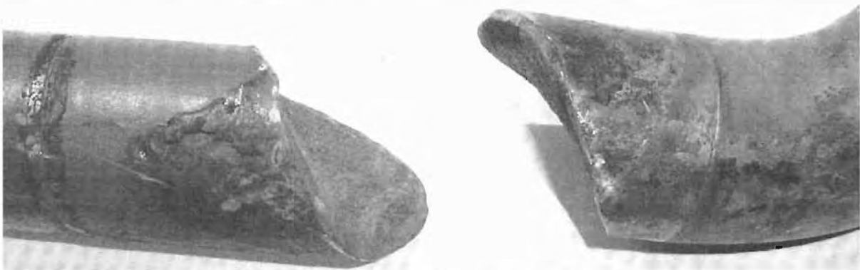
Figura 2.18 Fatiga por torsión, aspecto de zona de ruptura. Se trata de una barra de torsión de un autobús volvo (UDIATEM, 2004a). En este caso la fractura se presenta en la zona recta del eje, al nivel donde se encuentran los elementos de sujeción de la barra a la carrocería. La superficie es helicoidal
