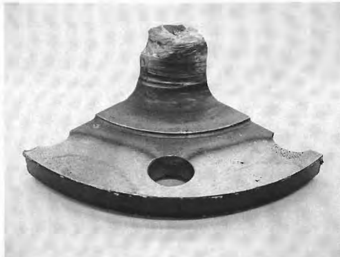
Figura 2.28 Zona de fractura del semieje de un vehículo de carga (UDIATEM, 2004b).
