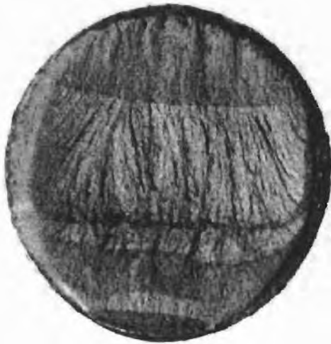
Figura 2.32 Superficie de una barra de acero con 0.35% C, 0.6% Mn, 1.89% Cr, 0.24% Mo, templada y revenida. La barra sufrió dos impactos sucesivos en la misma dirección. La grieta principal fue inducida por el primer impacto y la reacción elástica en el otro lado de la pieza dio inicio a una segunda grieta. En la superficie se observan las diferentes etapas del proceso de fractura, las cuales se pueden correlacionar con los ciclos de carga. (Stahleisen, 1997).
