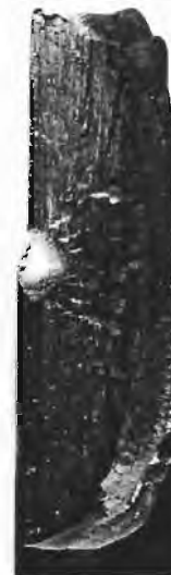
Figura 2.20 Fatiga a torsión. Vista longitudinal de un eje fracturado en servicio. Se trata de un acero con 0.15% de C, 1.12% de Mn y 0.98% de Cr. La grieta de fatiga se originó en la superficie siendo desviada paralela a las fibras del material, creciendo entonces en dirección longitudinal (Stahleisen, 1997).
