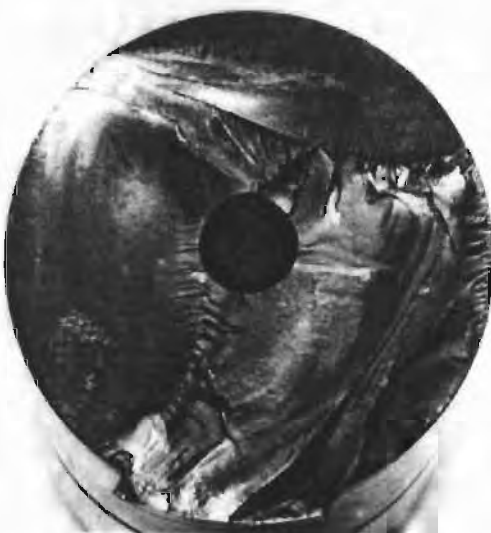
Figura 2.19 Eje de un acero 1060 que falló por fatiga a torsión. Las grietas de fatiga corrieron a partir de tres puntos en la superficie creciendo hacia el agujero de la pieza. (Stahleisen, 1997).
