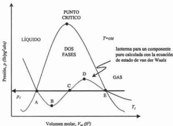
Fig. 4.2- Diagrama de fase de p vs. V_M a T constante para un componente puro mostrando el comportamiento volumétrico pronosticado por la ecuación de estado de van der Waals (ecuación 4.22).
