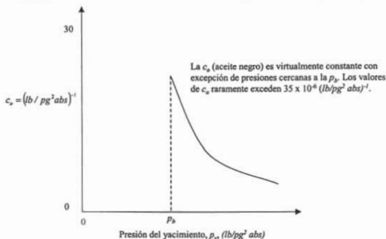
Fig. 5.17-Comportamiento de la c_o respecto a la presión del yacimiento, p_y , para un aceite negro a temperatura constante a una p > p_b
