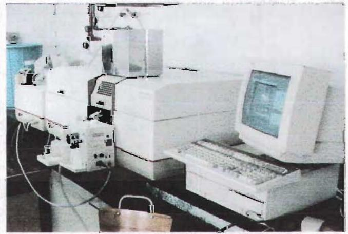
Figura 11. Equipo. Arriba: Horno de microondas "MARS 5", cerrado (izquierda), y mostrando en su interior el carrusel con vasos HP-500 plus. Al centro: celda de cuarzo y trampa (izquierda), a la derecha la celda de cuarzo montada sobre el horno del equipo de absorción atómica. Abajo: A la izquierda el generador de hidruros, y a la derecha vista general del espectrofotómetro de absorción atómica "SpectrAA-800".
