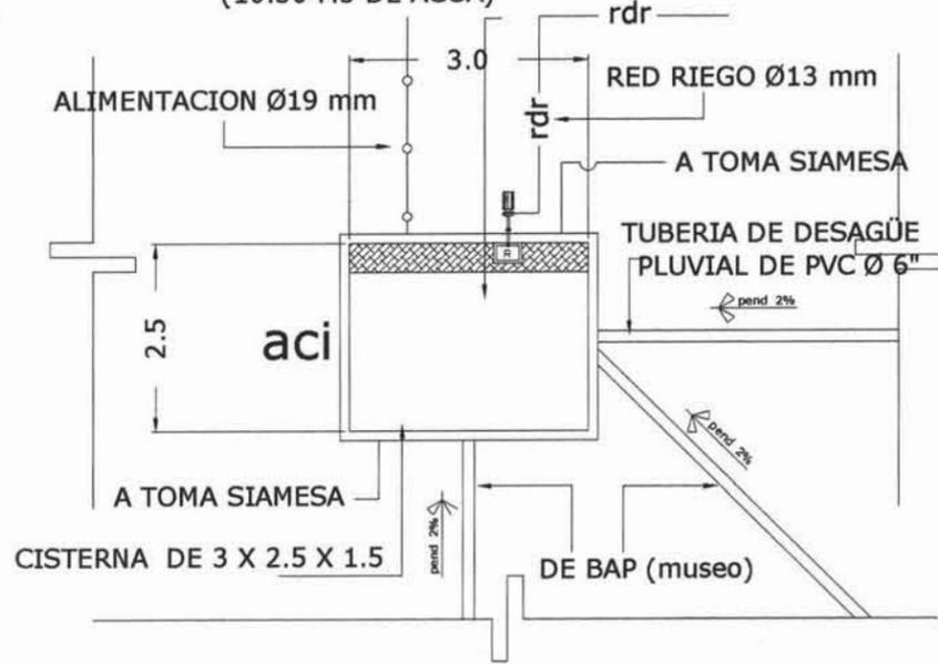
**Planta de Cisterna Pluvial**
