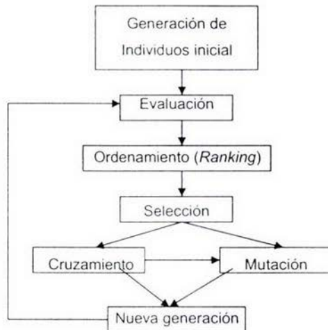
Figura II.8 Estructura principal de un algoritmo genético
