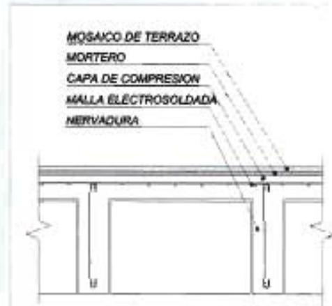
Fig. 2 Corte Esquemático de Losa de Entrepiso
