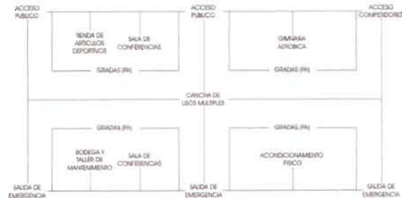
DIAGRAMA DE FUNCIONAMIENTO EN EL EDIFICIO DEL GIMNASIO
