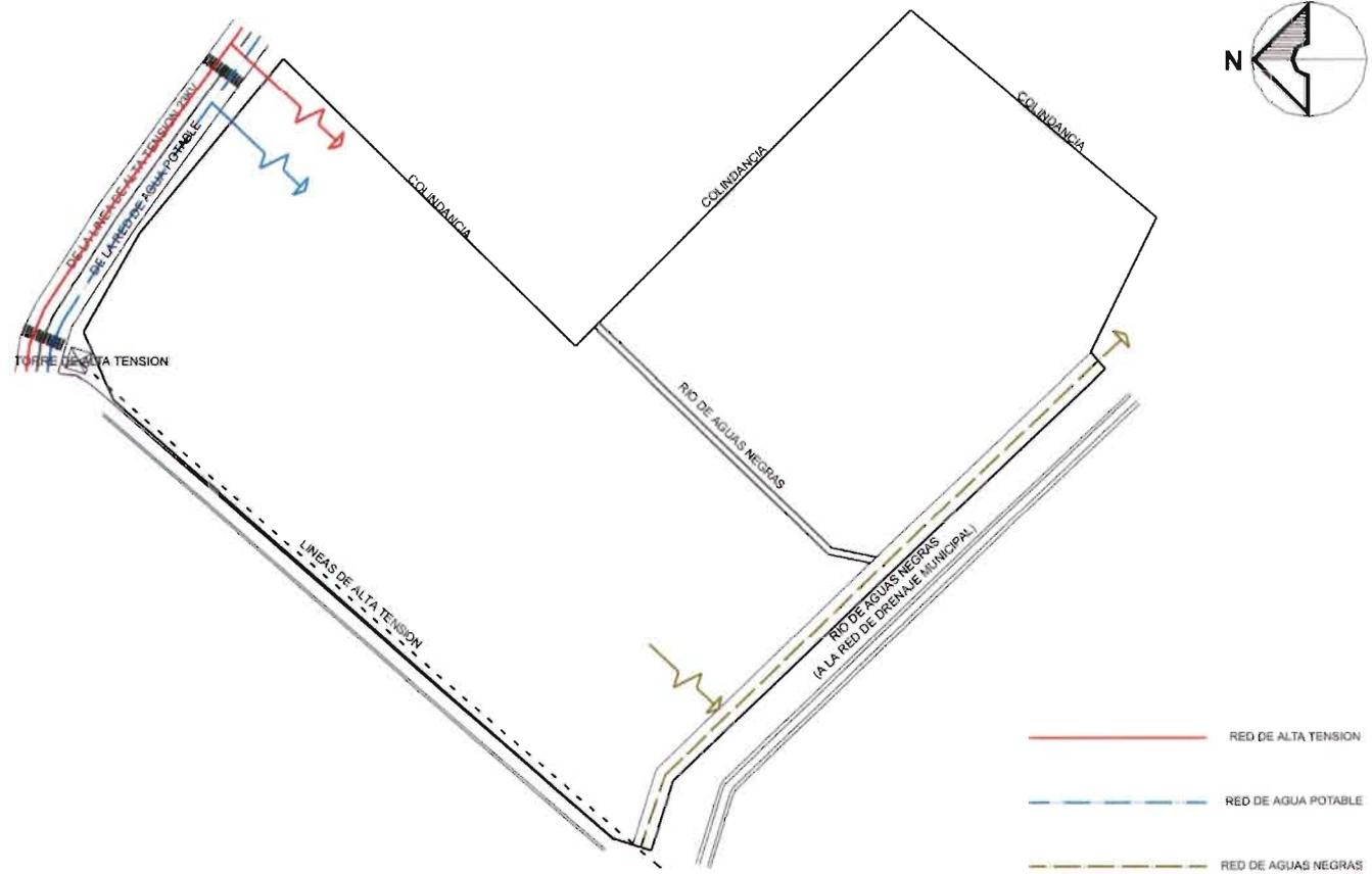
Fig. 5 Infraestructura hidráulica, sanitaria y eléctrica.
