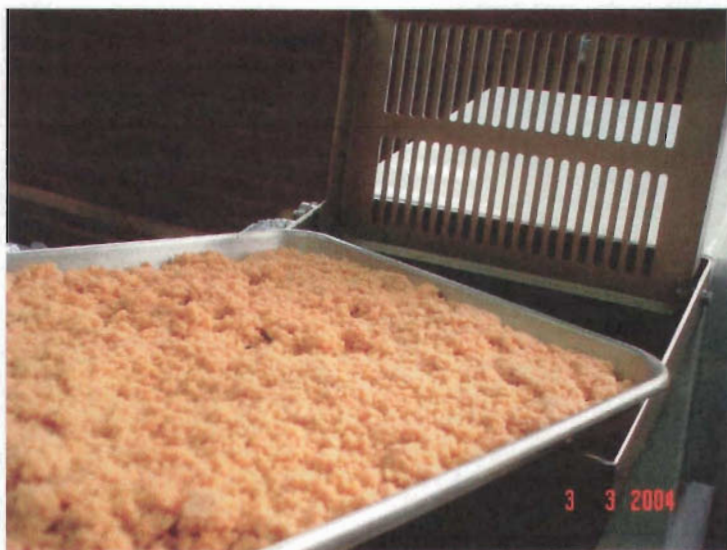
Figura 2.4. Alimentación del granulado con tratamiento térmico al extrusor
