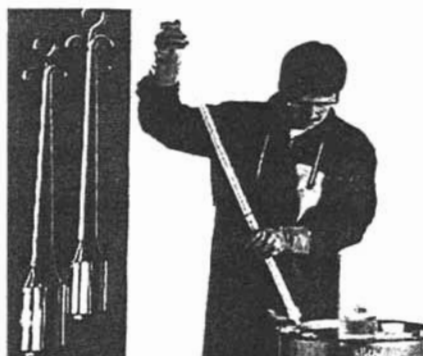
Figura 4. A la izquierda el Liquid-sampler en níquel plateado, a la derecha personal muestreando con un Liquid-sampler en polipropileno.
