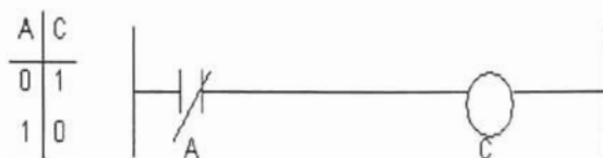
Figura 2.7.8. Arreglo en un diagrama de escalera y su tabla de verdad para función "NOT".
