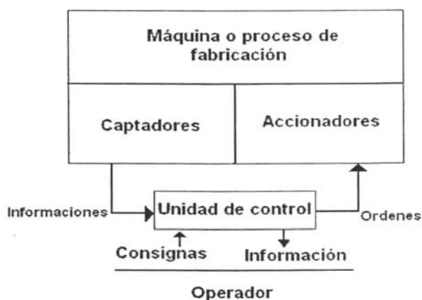
Figura 1.1.2. Esquema funcional de un sistema automatizado.
