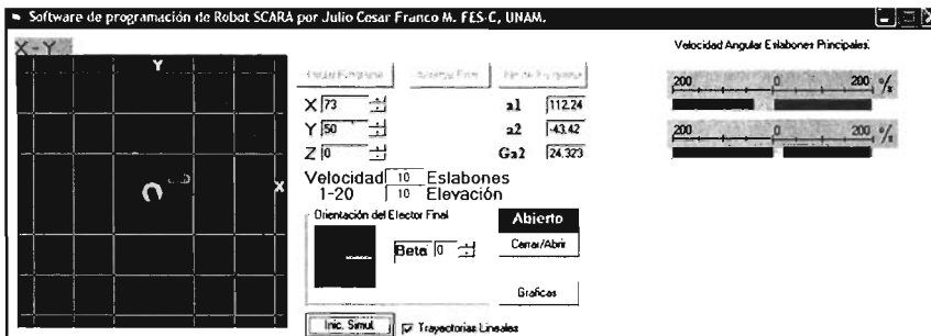
Figura 5.10, velocidad angular de los eslabones en tiempo real
