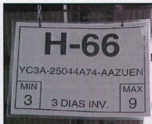
Figura 6.6.4.- Identificación de materiales en el mercado de llamado (Fuente: Industria Automotriz).
