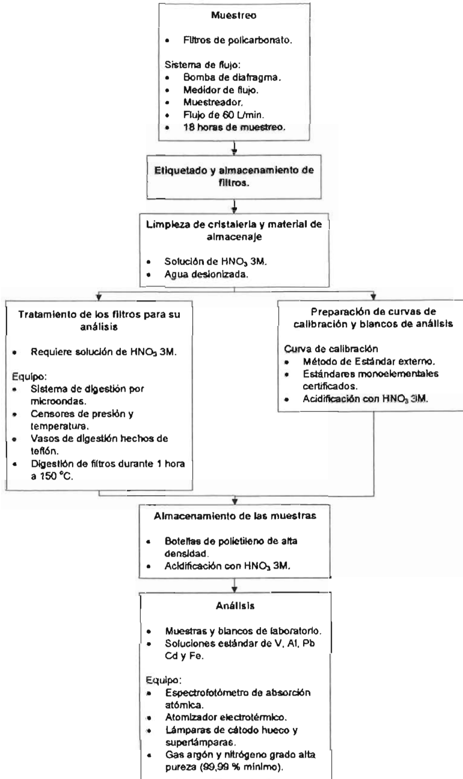
Figura 5. Método para la determinación de metales pesados en aerosoles.
