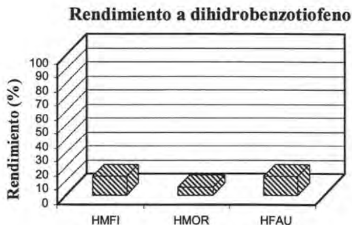
Figura 79. Rendimiento del dihidrobenzotiofeno obtenido sobre las zeolitas HMFI, HMOR y HFAU.
