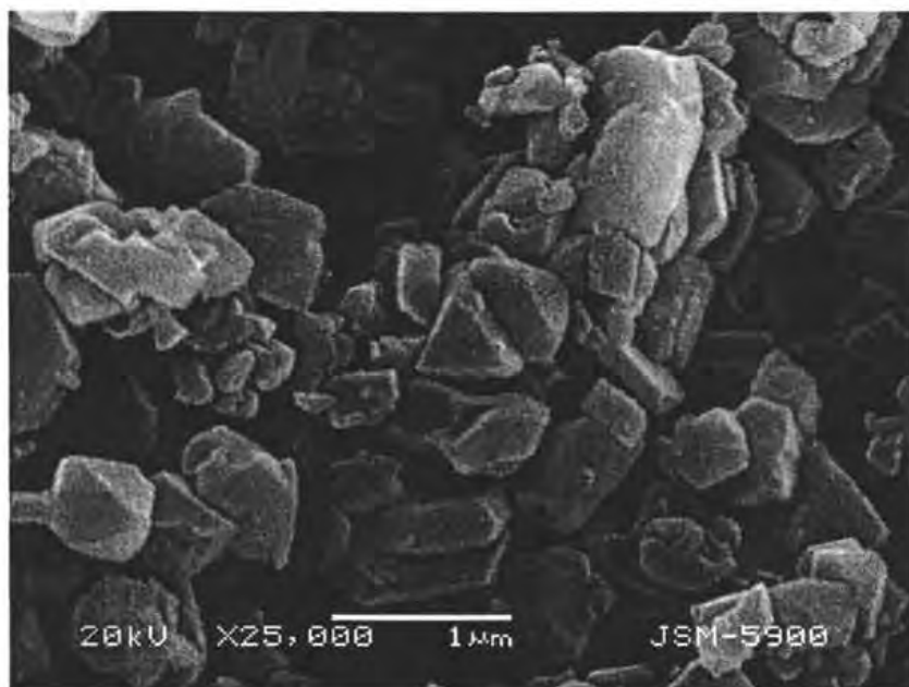
Figura 61. Micrografía de microscopía electrónica de barrido de la zeolita HFAU
