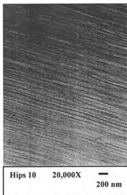
Figura 1.16: Imágenes de Microscopía Electrónica de Transmisión de HIPS 06, 08, 09 y 10. La fase oscura (oxidada con \text{OsO}_4 ) corresponde al PB, la fase clara al PS.
