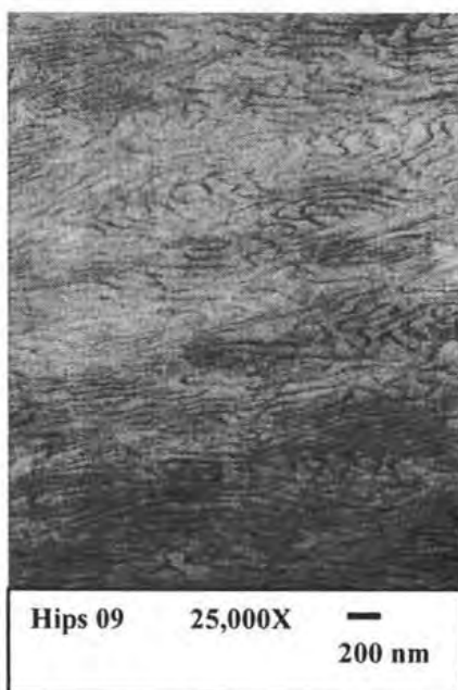
Figura 1.16: Imágenes de Microscopía Electrónica de Transmisión de HIPS 06, 08, 09 y 10. La fase oscura (oxidada con \text{OsO}_4 ) corresponde al PB, la fase clara al PS.
