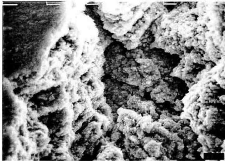
Fotografía 15.- (5861) Microestructura de una grieta cercana a la fractura (junto a la fractura) de una probeta deformada en medio salino ; 2000x, distancia entre marcas superiores = 10 \mu\text{m} ; \dot{\epsilon} = \times 10^{-4} \text{seg}^{-1} .
