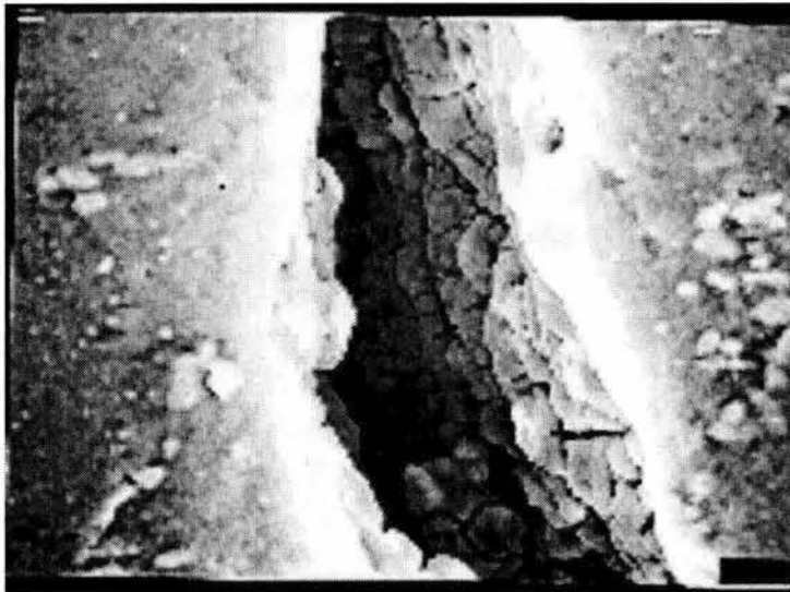
Fotografía 27.- (5732) Grieta cercana a la fractura, probeta deformada en medio salino ; 1000x, distancia entre marcas superiores = 100 \mu\text{m} ; \dot{\epsilon} = \times 10^{-6} \text{seg}^{-1} ; sin pulir. Se puede apreciar algunos compuestos depositados en la pared interna de la grieta.
