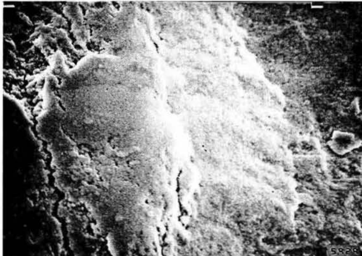
Fotografía 19.- (5929) Fractura frágil ( 90^{\circ} ) de una probeta deformada en medio salino ; 1000x, distancia entre marcas superiores = 100 \mu\text{m} ; ( \dot{\mathcal{E}} = \times 10^{-6} \text{seg}^{-1} ).
