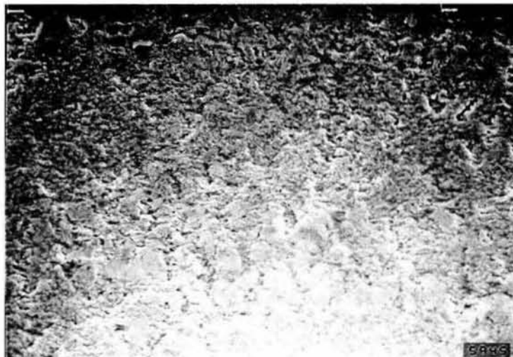
Fotografía 24.- (5945) Microestructura de la zona intermedia entre la fractura y el extremo opuesto (base de la zona de prueba) de una probeta deformada en medio ambiente y sin pulir; 1000x, distancia entre marcas superiores=100 \mu\text{m} \dot{\epsilon} = \times 10^{-6} \text{ seg}^{-1} .
