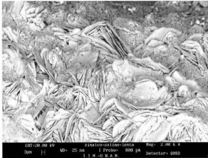
Fotografía 32.- (SLSP007) Vista general de la fractura, primer acercamiento misma probeta y zona de la foto 31 pero a una amplificación 2000x.
