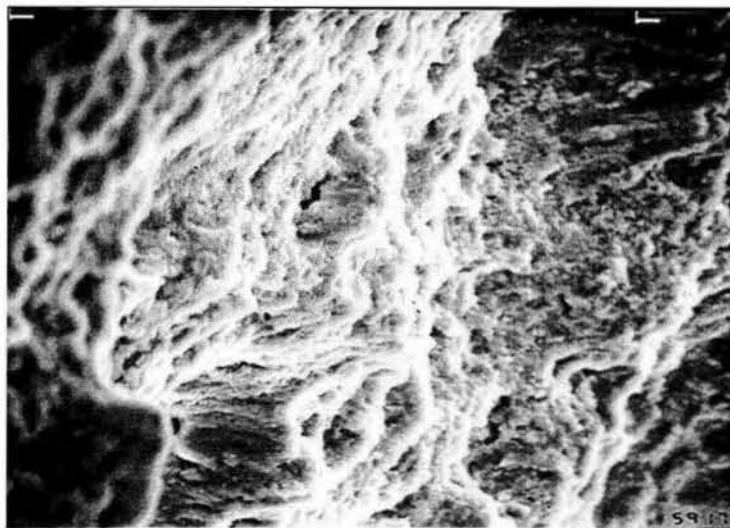
Fotografía 4.-Fractura de la probeta deformada en medio salino ; distancia entre marcas superiores = 100 \mu\text{m} ; se observa una fractura dúctil con oquedades de estructura gruesa que resalta como "gusanitos".
