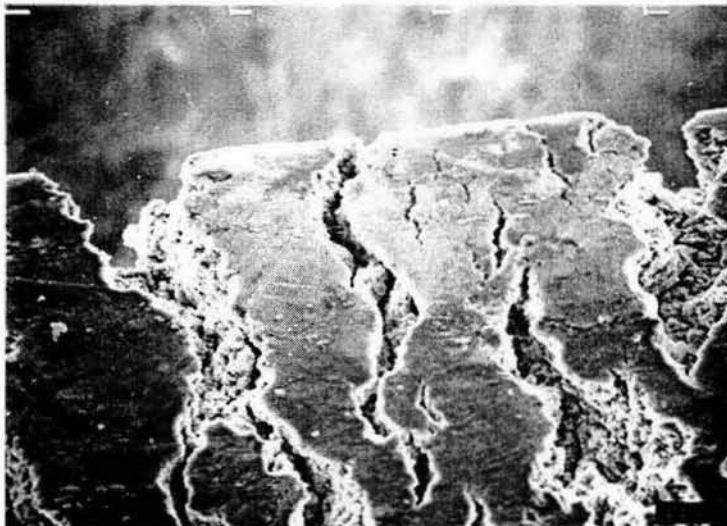
Fotografía 16.- (5862) Vista general de la orilla de una probeta deformada en medio salino; 350x, distancia entre marcas superiores = 100\mu\text{m} ; \dot{\epsilon} = \times 10^{-4} \text{seg}^{-1} .
