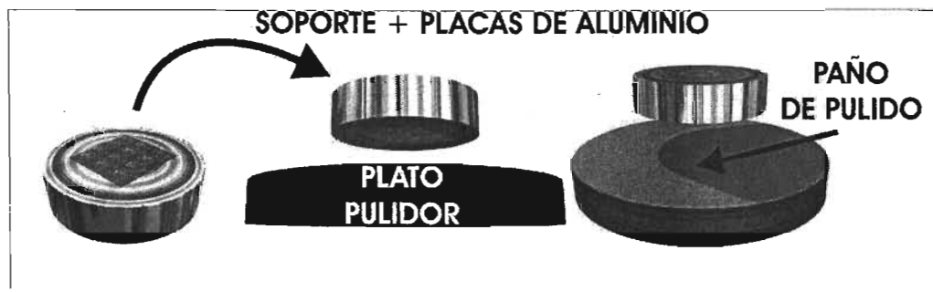
Figura 4.2. Muestras de aluminio colocadas sobre el portamuestras, éstas se pulen con polvos de diferentes tamaños, para lograr una superficie casi a espejo.
