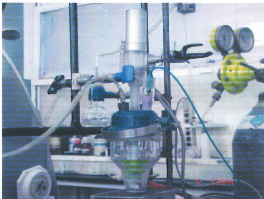
Figura 3. 3. Fotografía de la celda electroquímica para llevar a cabo estudios voltamperométricos y coulombimétricos.
