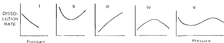
Figura 3.16 Varios tipos de correlaciones observadas entre la fuerza de compresión aplicada durante la fabricación de las tabletas y la velocidad de disolución.
