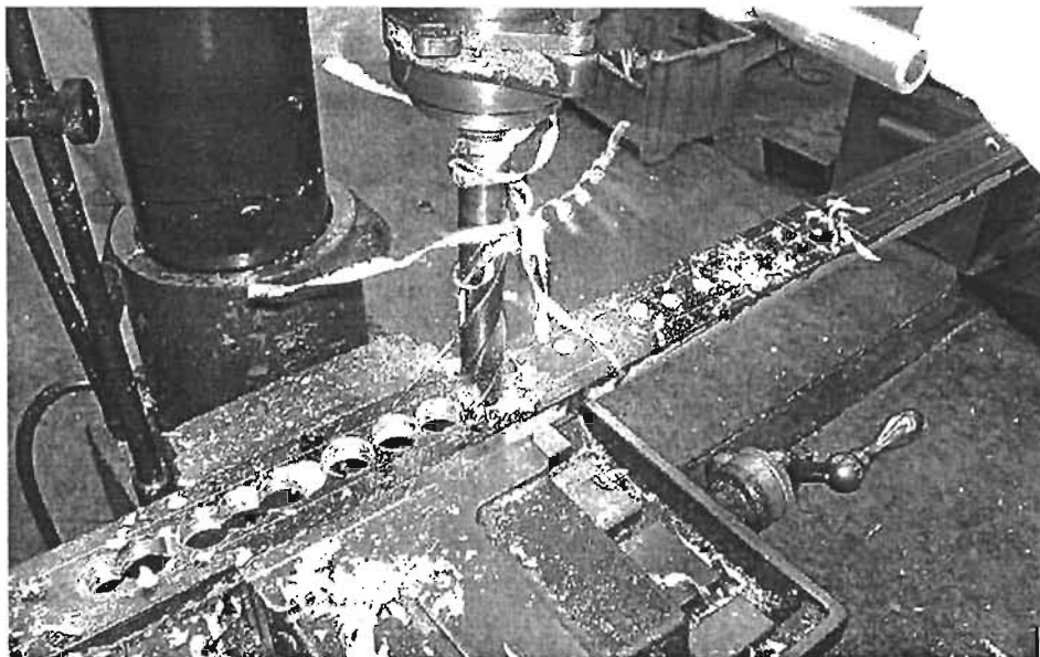
Figura 3.1 Barrenado a cada una de las barras, para facilitar el perfil deseado de la ranura.
