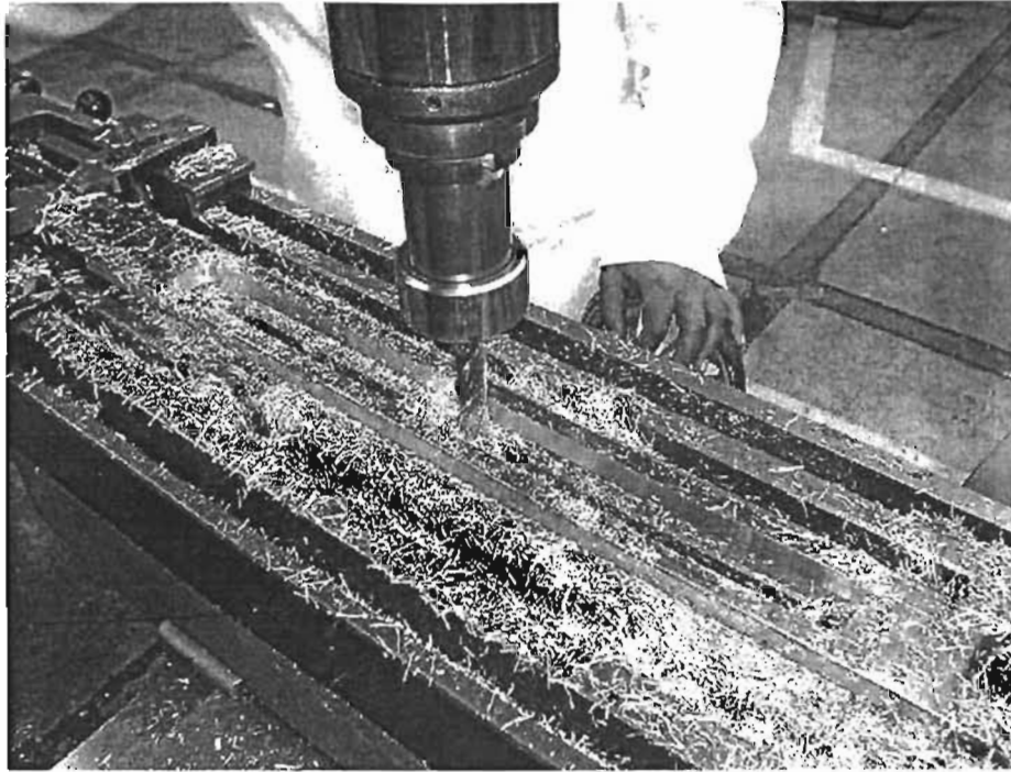
Figura 3.3 Finalizando el perfil deseado de la ranura
