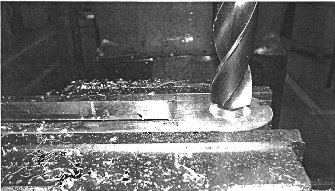
Figura 3.13 Barrenado para la colocación de las tazas
