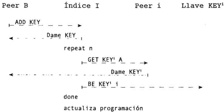
Figura 2.7: Agregando bloques al canal.
