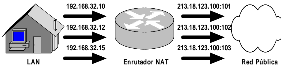
Figura 69. Con PAT, cada dirección IP de los hosts de la LAN es traducida a la misma dirección IP (213.18.123.100), pero asignándole un número de puerto diferente
